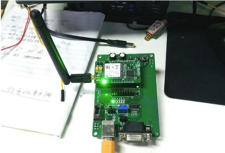
打开串口软件“9.4 sscm32 串口调试软件.exe”，勾选“HEX 发送”（所有修改指令都必须是以 HEX 形式发送），发送指令 BB A5 5A 01 00 02 01 01 A5 CC 查询工作状态，查看返回的数值是否为下图所示：
