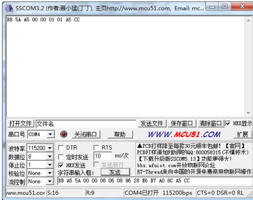
接着向串口发送 BB A5 5A 00 00 03 01 00 00 A5 CC (进入透传模式);
